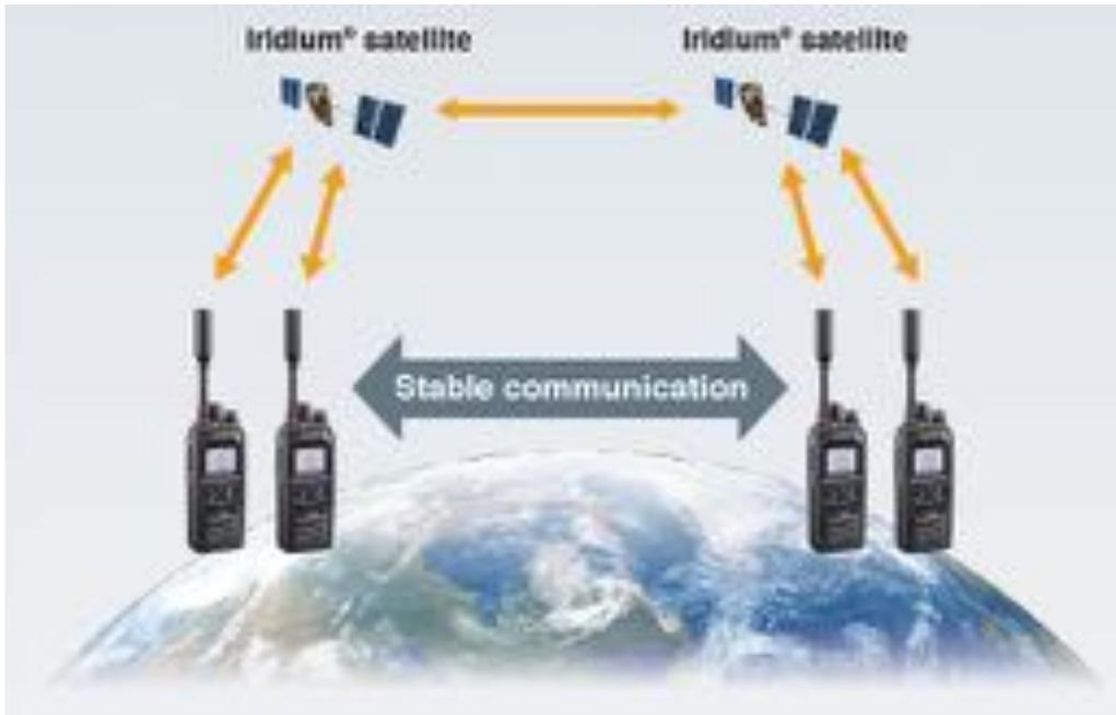
La solution «**PTT Satellite**» a été conçue sur la base d'un portatif de radiocommunication professionnel s'appuyant sur le réseau de communication par satellite d'Iridium. Cet équipement permettra d'établir en temps réel et dans le monde entier des communications individuelles ou de groupe par simple appui sur un bouton PTT (Push-To-Talk).
